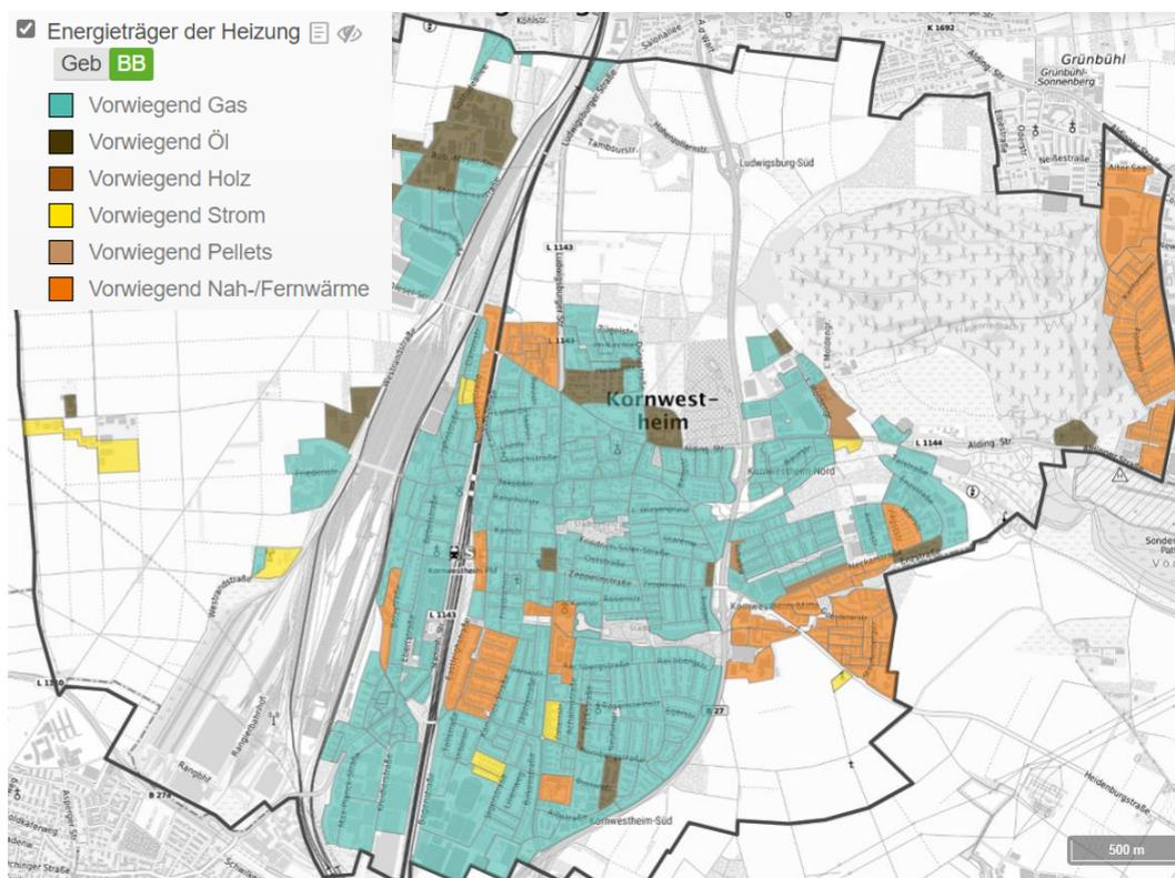
Abb. 18: Energieträgerverteilung der Heizungen in Kornwestheim (vorwiegender Energieträger auf Baublockebene)
