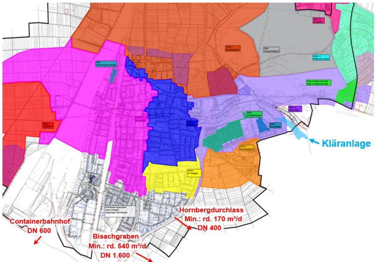
Abb. 33: Entwässerung Stadtgebiet (farblich hinterlegte Bereiche an eigene Kläranlage angeschlossen)
