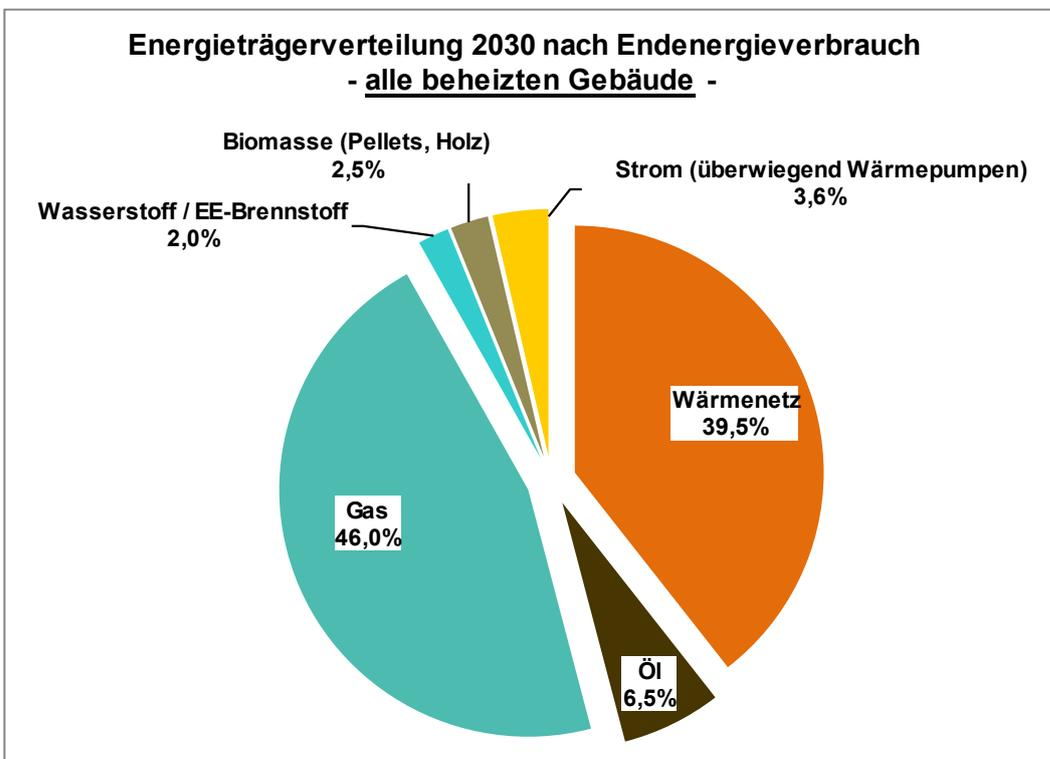
Abb. 46: Prozentuale Deckung des Endenergiebedarfs zur Wärmeerzeugung nach Energieträgern im Zwischenzielszenario 2030 (Endenergie Wärmepumpen ohne Umweltwärmeanteil)
