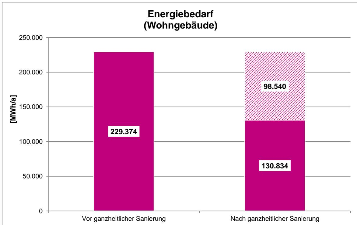
Abb. 25: Einsparpotenzial Endenergiebedarf Wohngebäude (für Wärme) durch bauliche Gebäudemodernisierung
