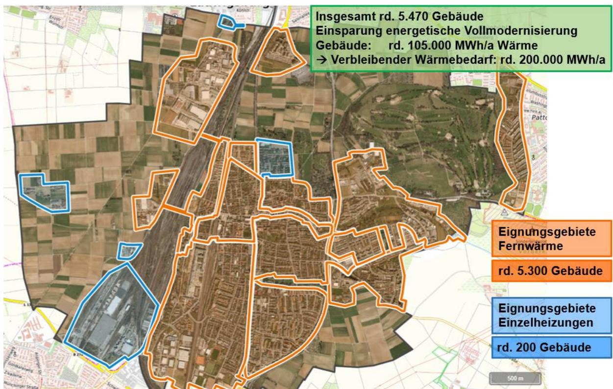
Abb. 44: Eignungsgebiete für Wärmenetze und Einzelheizungen
