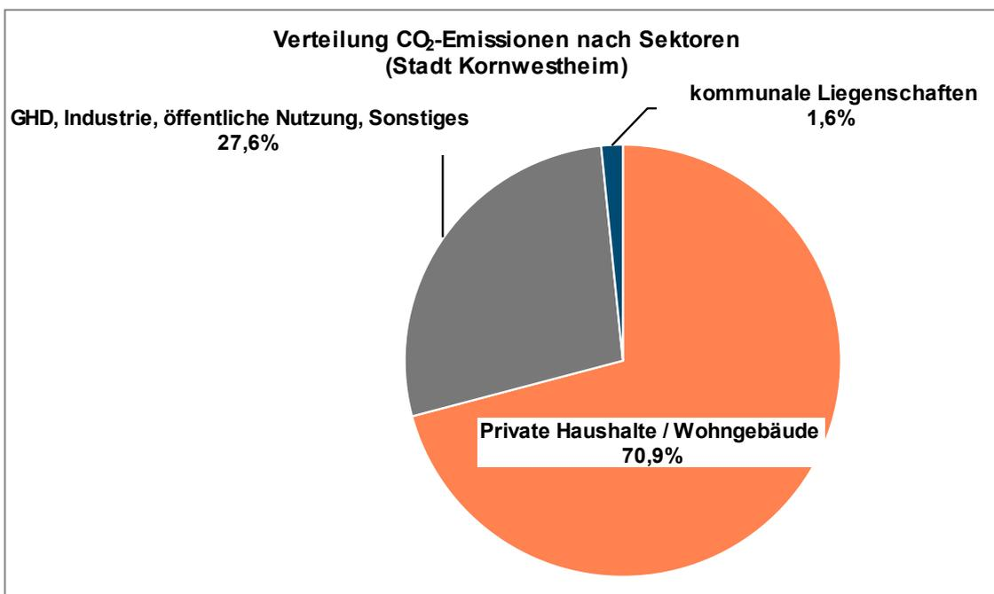
Abb. 23: CO<sub>2</sub>-Emissionen Wärmeerzeugung nach Sektoren (IST)
