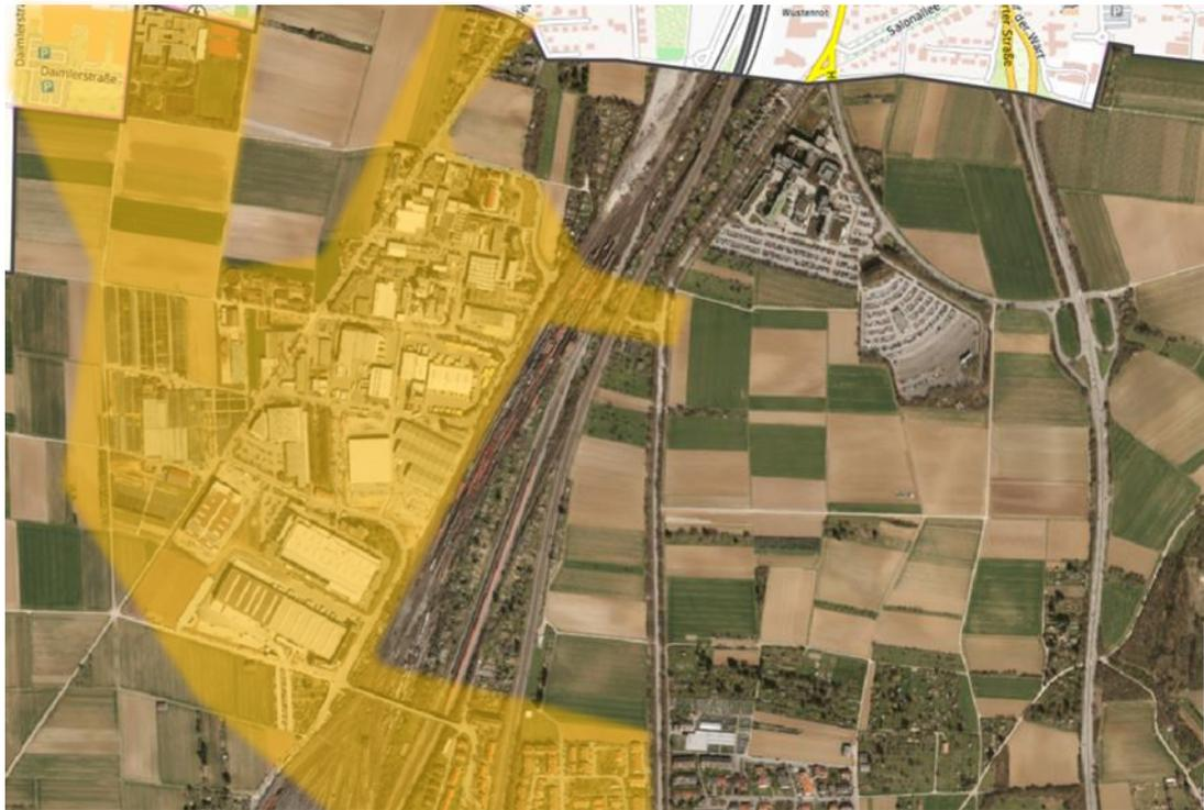
**Abb. 60:** möglicher Netzausbaubereich mit Anbindung an die bestehenden Wärmenetze mit Fokus auf Einbindung der vorhandenen Abwärmepotenziale im Gewerbegebiet Nord
