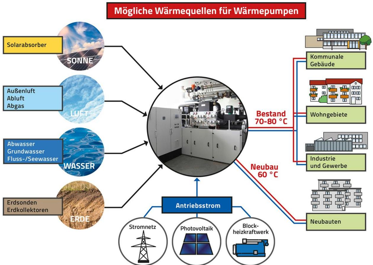
Abb. 37: Wärmequellen für Wärmepumpen
