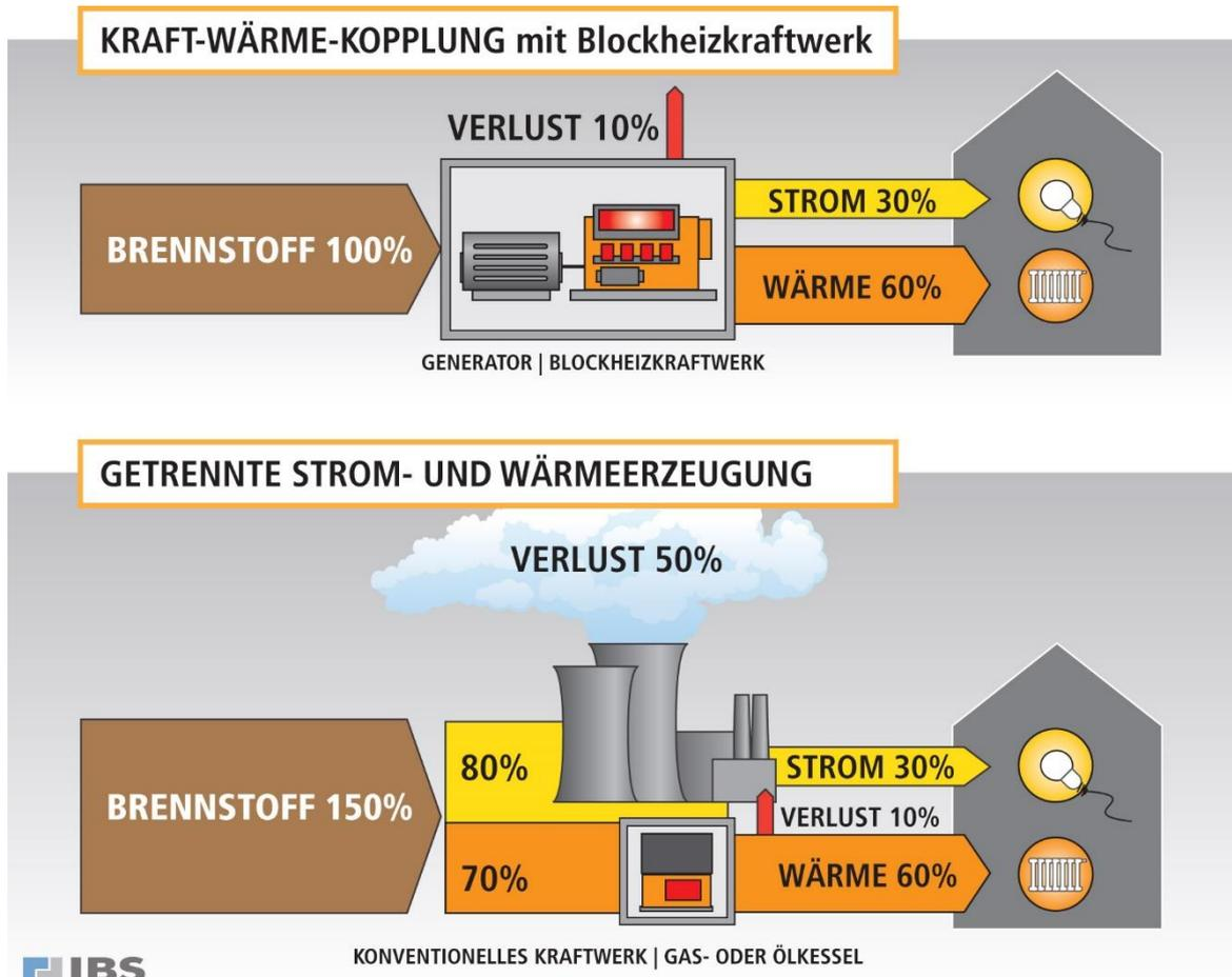
Abb. 32: Prinzip Kraft-Wärme-Kopplung im Vergleich zu getrennter Strom- und Wärmeerzeugung
