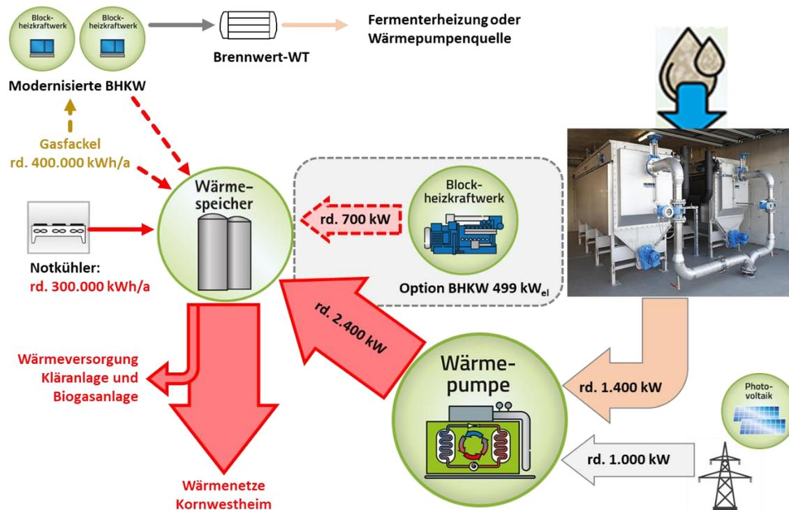
Abb. 36: künftig mögliche Energieflüsse Kläranlage und Abwasserwärmenutzung (Auszug Beratungsbericht IBS)
