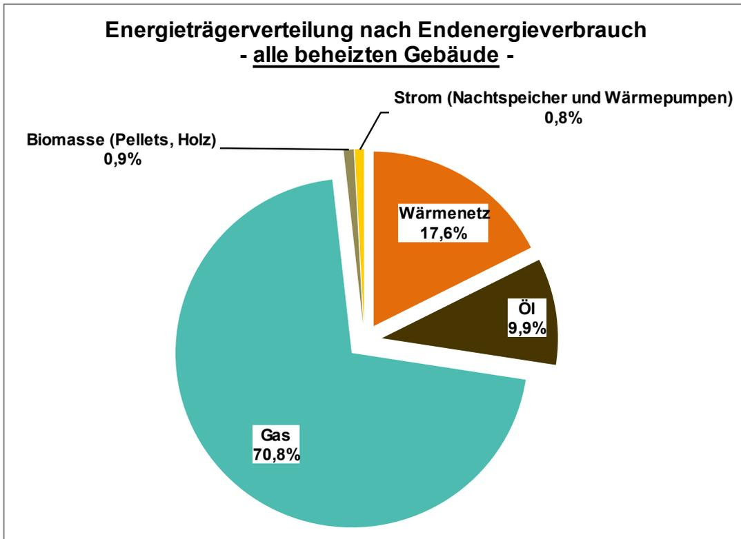
Abb. 22: Prozentuale Deckung des Endenergiebedarfs zur Wärmeerzeugung nach Energieträgern (IST)
