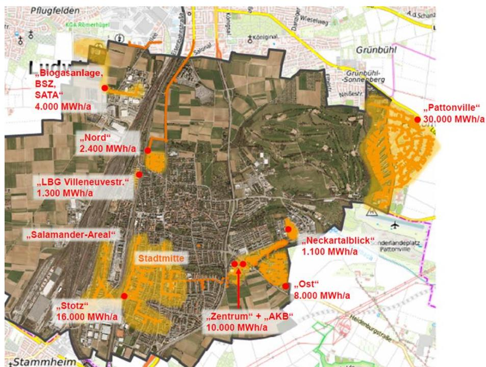
Abb. 59: Übersicht Heizzentralen bisheriger Wärmenetzbestand
