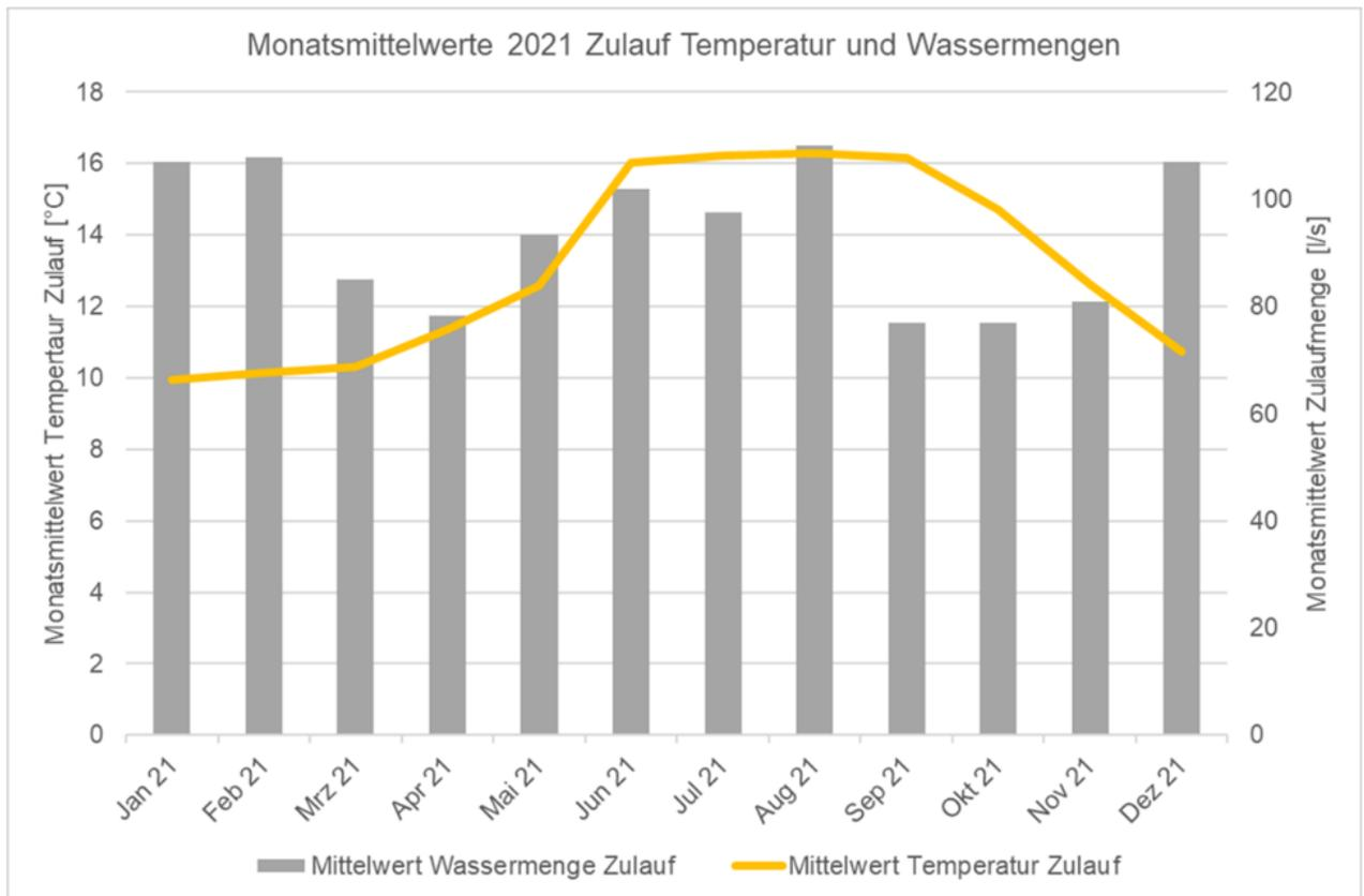
Abb. 35: Verlauf der Wassermengen und der Wassertemperatur (Auszug Beratungsbericht IBS)
