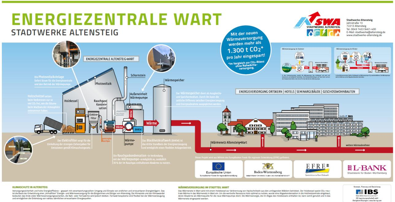
Abb. 30: Beispiel Heizzentrale Altensteig-Wart mit Hackschnitzelheizung und Wärmepumpe (Sommer Außenluft/ Winter Abgaskondensation)
