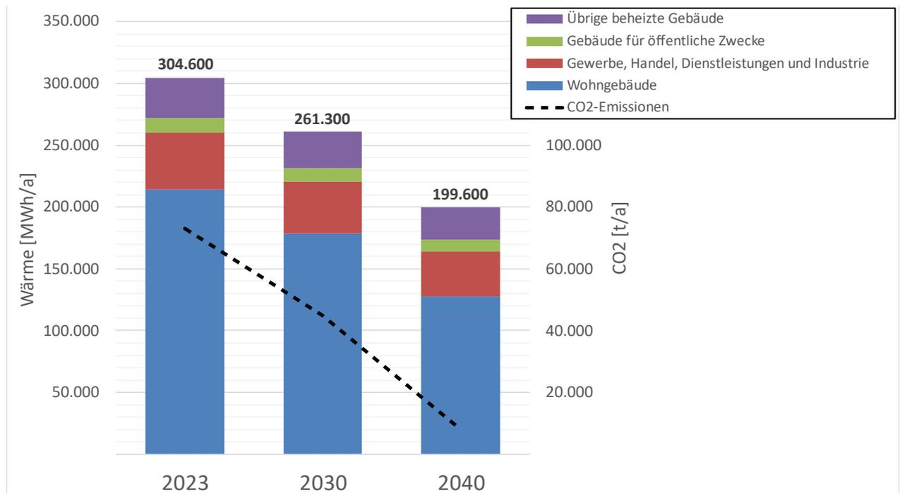
Abb. 57: Entwicklung Wärmeverbrauch und CO2-Emissionen - Zielfoto Wärmeversorgung bis 2040
