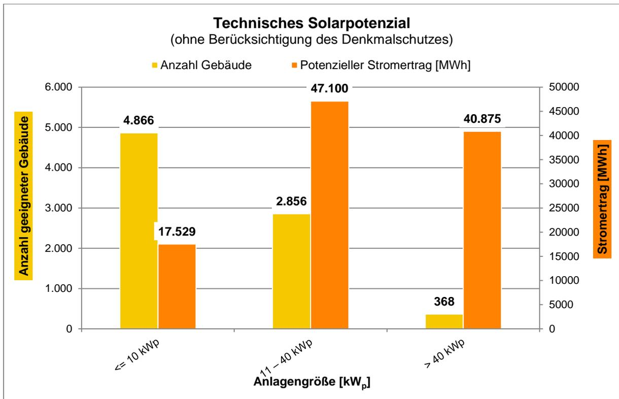
Abb. 42: Anzahl möglicher PV-Anlagen nach Anlagengröße und deren Erzeugungspotenzial
