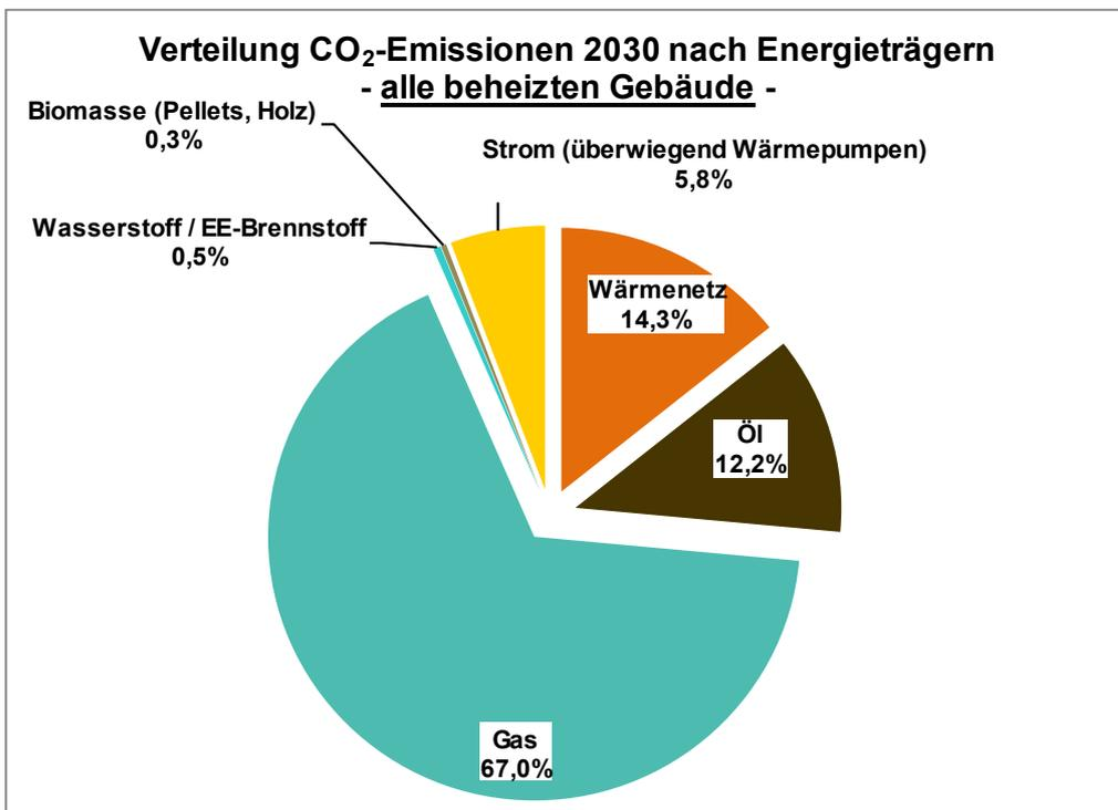
Abb. 48: Prozentuale Verteilung der CO<sub>2</sub>-Emissionen zur Wärmeerzeugung nach Energieträgern (Zwischenzielszenario 2030)
